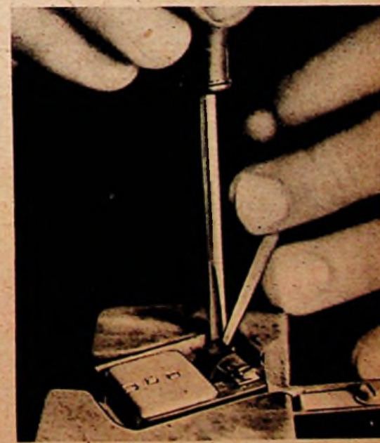
Einbau der Schutzrolle. Eine abgellachte Rolle verhindert beim Aufsetzen eine Beschädigung des Saphirs
